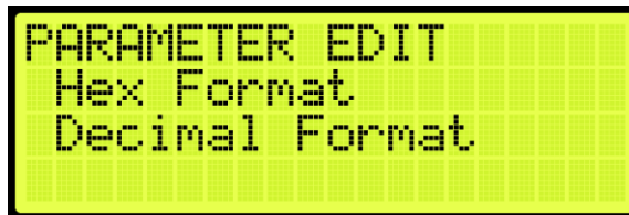
Figure 70: PARAMETER EDIT Menu – Hexadecimal or Decimal Format
