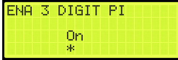
Figure 459: ENABLE 3 DIGIT PI Menu
